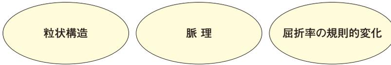
粒状構造と脈理は投影写真によって写し出すことができます。微細な脈理や屈折率の規則的变化は、干渉計によるか、またはフォーコー (Foucault) の方法によらなければ確認できません。図2に典型的な脈理の投影写真を、図3に脈理フリーの超高品質石英ガラス材料の投影写真を示します。
