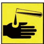
傷害危険 薬傷注意
